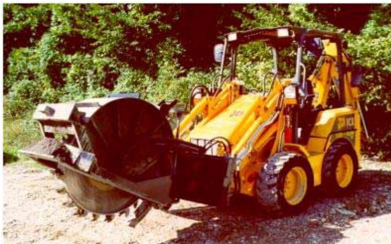
**Figura 2/L.48 – Ejemplo de una máquina de corte convencional**
